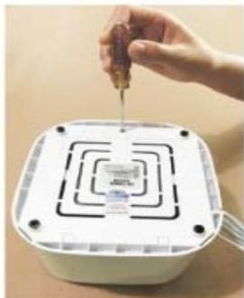
Odkręć śrubki na dole obudowy
